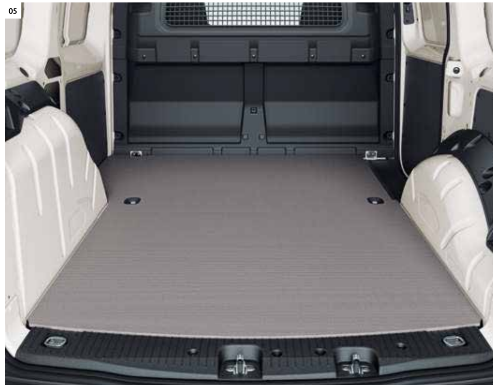
05 Drvena podna obloga. Idealno pogodna za utovar euro paleta. Robusna bukovina debljine 10 mm, lijepljena u 5 slojeva, nudi protukliznu površinu.
